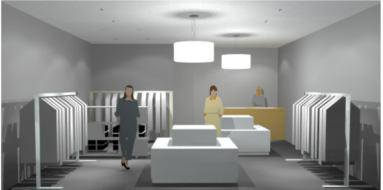
Figura 172 Imagem virtual da loja-tipo com iluminação pontual directa, para destaque dos produtos.
